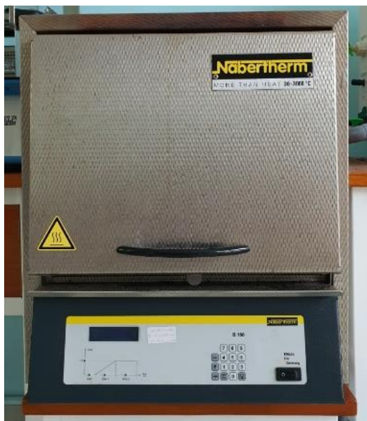
Hình 3.17. Tủ nung Nabertherm, Đức
