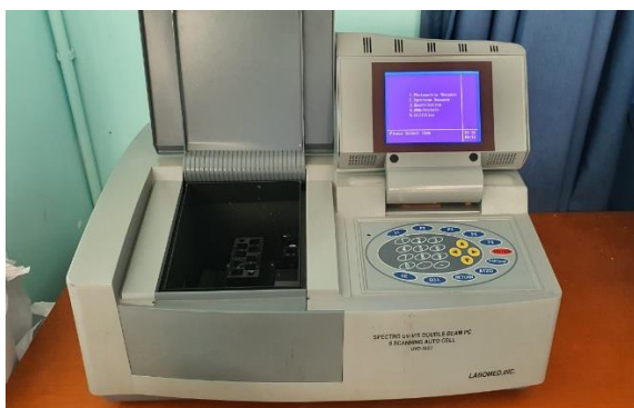
H ình 3.9. Máy quang phổ UV-VIS 2 chùm tia, UVD-3200 Labomed, Mỹ
