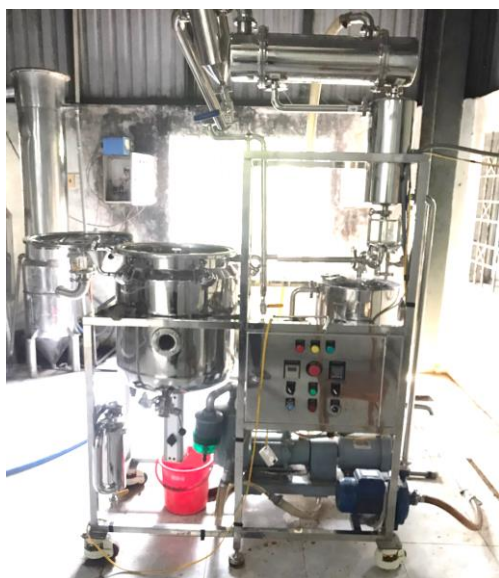
H ình 3.29. Máy chiết siêu âm bán công nghiệp (năng suất 20 lít/mẻ)
