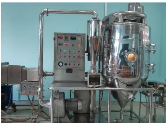
Hình 3.21. Hệ thống máy sấy phun đĩa
