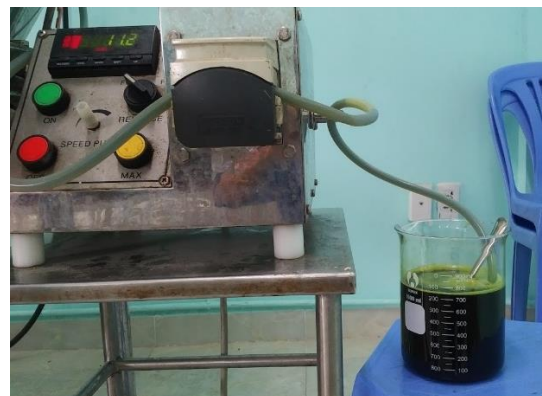
Hình 3.20. Sấy phun dịch chiết rau má sau cô đặc
