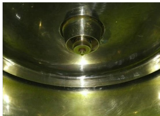
Hình 3.22. Đĩa phun máy sấy phun
