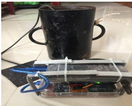
Hình 2.3: Bộ cảm biến đo tốc độ chìm của giềng chì
