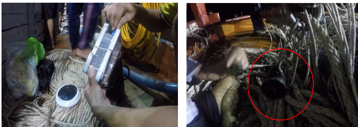
Hình 3.29: Công tác chuẩn bị và gắn thiết bị đo tốc độ chìm vào giềng chì
