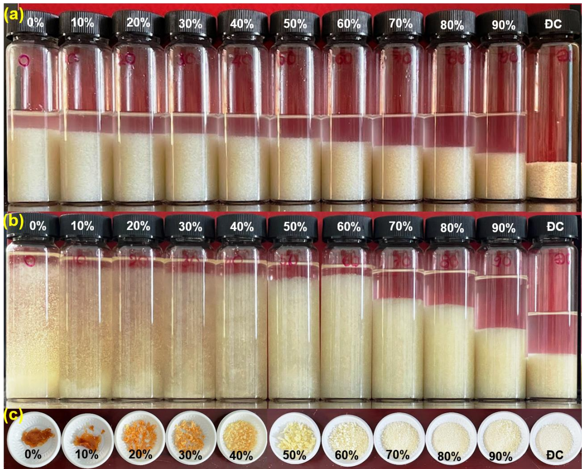
Hình 3.16. Chitosan ngâm trương nở trong EtOH/H 2 O ở các tỷ lệ dung môi khác nhau (a), chitosan sau trương nở phản ứng với lactic acid 1M trong 6h (b) và chitosan lactate (c) thu được.
