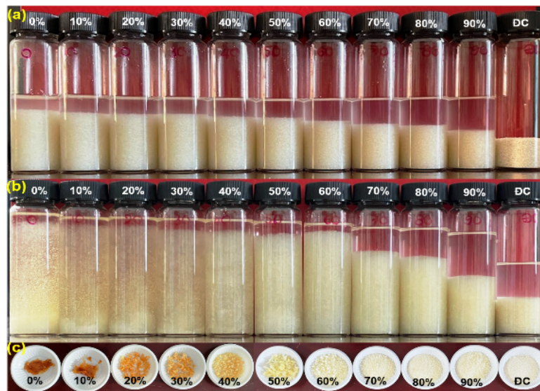
Hình 3.16. (a) Chitosan ngâm trương nở trong EtOH/H 2 O ở các tỷ lệ dung môi khác nhau, (b) chitosan sau trương nở phản ứng với lactic acid và (c) chitosan lactate thu được.
