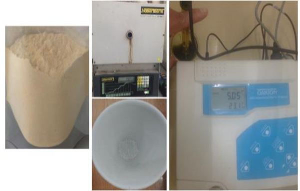
Hình 3.8. Kiểm tra chất lượng bột đẳng sâm sấy phun
