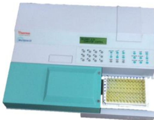
Hình 2.9. Chiết xuất, ủ và đọc mẫu trên máy ELISA ở bước sóng 405 nm
